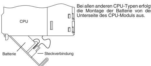
Bei allen anderen CPU-Typen erfolgt die Montage der Batterie von der Unterseite des CPU-Moduls aus.
