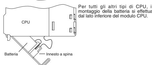
Prima di mettere in funzione la CPU, collegare la batteria. Aprire a tal fine il vano batteria del modulo ed assicurarsi che la batteria è correttamente inserita. Collegare quindi il connettore della batteria con il particolare opposto nel supporto della batteria o nel modulo CPU. Nel caso della CPU Q02(H), Q06H, Q12(P)H e Q25(P)H, controllare che l'innesto a spina sia inserito nel supporto previsto nel vano batteria.
