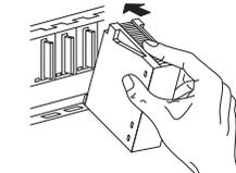
2 Pak modul přitlačte ke sběrnicí tak, aby přilehl celou plochou na sběrnicí.
