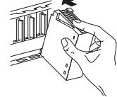
③ W przypadku usytyuowania instalacji w takich miejscach, gdzie spodziewane są drgania, moduł należy zabezpieczyć przy pomocy śruby mocującej (M3 x 12). Śruby te nie są dostarczane wraz z modelem.
