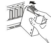
② Затем плотно прижмите модуль к базовому шасси и убедитесь, что он вошел до конца.
