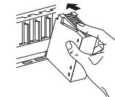
② Seguidamente, empuje el módulo contra la unidad base hasta que el módulo quede pegado a la misma.
