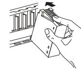
② Appuyez sur le module dans le sens de la flèche pour le placer dans le châssis de base.
