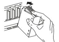
② Appuyer ensuite fermement sur le module dans le châssis de base en s'assurant qu'il soit totalement enfoncé dans le châssis de base.
