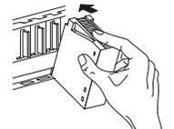
2 Затем плотно прижмите модуль к базовому шасси и убедитесь, что он вошел до конца.
