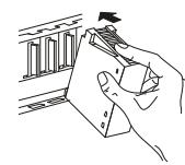
② Appuyer ensuite fermement sur le module dans l'appareil de base en s'assurant qu'il soit totalement enfoncé dans l'appareil de base.
