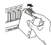
② Drücken Sie das Modul anschließend auf den Baugruppenträger, bis das Modul ganz am Baugruppenträger anliegt.
