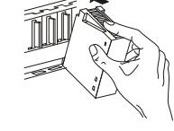
② Затем плотно прижмите модуль к базовому шасси и убедитесь, что он вошел до конца.
