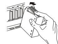
② Drücken Sie das Modul anschließend auf den Baugruppenträger, bis das Modul ganz am Baugruppenträger anliegt.
