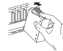
② Appuyer ensuite fermement sur le module dans l'appareil de base en s'assurant qu'il soit totalement enfoncé dans l'appareil de base.
