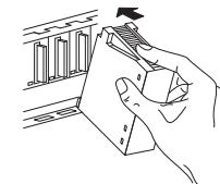
② Seguidamente, impulse el módulo contra la unidad base hasta que el módulo quede pegado a la misma.
