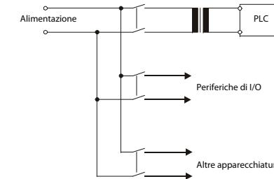
Per minimizzare la caduta di tensione usare per la linea di alimentazione dei cavi con conduttori con la massima sezione possibile (max. 2 mm<sup>2</sup>). Collegare degli scaricatori di sovravoltaggio per proteggere il sistema da picchi di tensione (ad es. fulmini).
