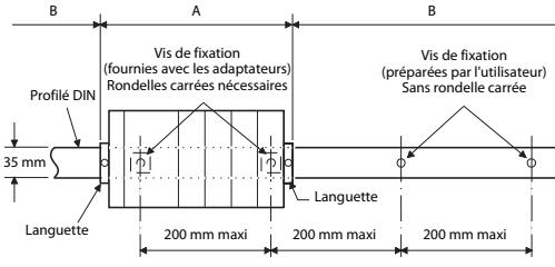
Insérez les vis de fixation et les rondelles carrées fournies (voir ci-dessous).
