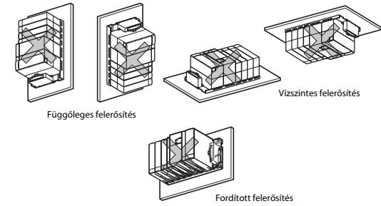
Az alapegyeset egy lapos, falszerű felületre kell felszerelni a mechanikus feszültségek megelőzése érdekében.
