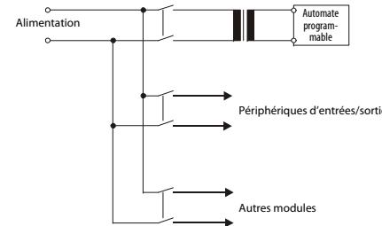
Pour minimiser les chutes de tension, utilisez des câbles de section maximale (maxi 2 mm<sup>2</sup>) pour les lignes d'alimentation. Montez des parafoudres pour protéger le système contre les pointes de tension (ex. éclair).
