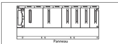
⑤ Insérez les vis inférieures et serrez toutes les vis pour fixer le châssis sur la cloison.
