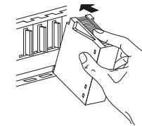
③ Sichern Sie das Modul zusätzlich mit einer Schraube (M3 x 12), wenn Vibrationen zu erwarten sind (Anzugsmoment der Schraube: 0,36 bis 0,48 Nm). Diese Schraube gehört nicht zum Lieferumfang der Module.
