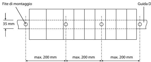
Se si installa la guida DIN in un ambiente soggetto a forti sollecitazioni di vibrazioni o urti, inserire le viti di fissaggio a intervalli massimi di 200 mm, con il metodo indicato di seguito.
