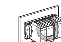
Weil die SPS Wärme erzeugt, sollte sie an einem gut belüfteten Ort in der links abgebildeten Position montiert werden. Die SPS darf nicht vertikal, umgekehrt oder flach liegend montiert werden, da so keine ausreichende Lüftung möglich ist. Montieren Sie die SPS nicht in eine der im Folgenden dargestellten Positionen.
