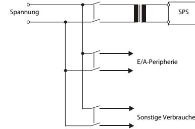
Zur Minimierung des Spannungsabfalls ist für die Netzeitungen der maximal mögliche Querschnitt zu verwenden (max.  $2 \text{ mm}^2$ ).
