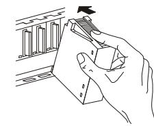
③ Fixez le module avec une vis M3 x 12 aux emplacements où des vibrations sont probables. (Couple de serrage : 0,36 à 0,48 N.m) Ces vis ne sont pas fournies avec les modules.
