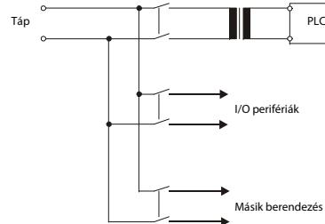
A hálózati feszültség veszteségeinek minimalizálása érdekében a tápfeszültség biztosítására használjon a lehető legnagyobb (legfeljebb 2 mm<sup>2</sup>) keresztmetszetű kábeleket.
