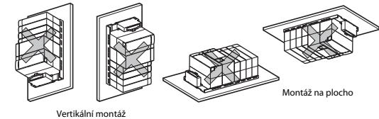
Základní sběrnici instalujte na rovný podklad tak, aby nedocházelo k jejímu mechanickému namáhání.
