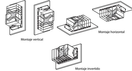
La unidad base hay que montarla sobre una base horizontal plana para evitar tensiones.
