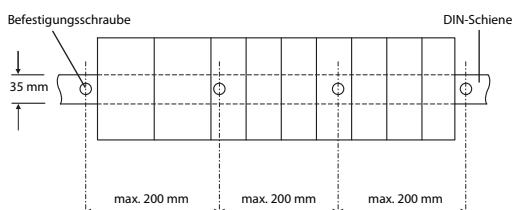
Falls die DIN-Schiene in einer Umgebung installiert wird, in der starke Vibratoren und/oder Stöße auftreten, müssen die Befestigungsschrauben mit einem maximalen Abstand von 200 mm wie folgt angebracht werden:
