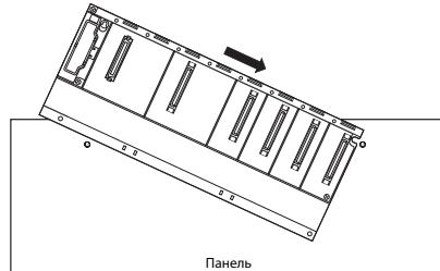
④ Наденьте шасси левым монтажным отверстием на другой винт.
