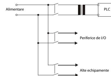
Pentru a reduce la minimum pierderile de tensiune ale liniei utilizăți cabluri cu secțiune maximă posibilă (max. 2 mm<sup>2</sup>) pentru liniile de alimentare. Instalați dispozitive de protecție la supratensiuni pentru a proteja sistemul împotriva supratensiunilor (de ex. fulgere).
