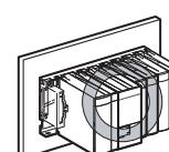
Como el PLC genera calor, es necesario montarlo en un lugar bien ventilado en la posición representada a la izquierda. El PLC no puede montarse verticalmente, invertido ni tumbado, ya que así no resulta posible una ventilación suficiente. No monte el PLC en ninguna de las posiciones representadas a continuación.
