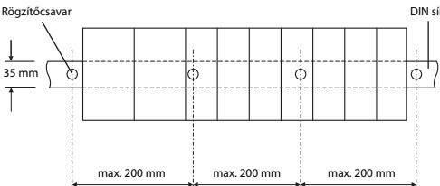
Ha a DIN sír erős rezgéseknek és/vagy rázkódásoknak kitett környezetbe kerül felszerelésre, akkor a rögzítőcsavarokat a lenti ábrán látható módon kell behelyezni úgy, hogy az egymás közötti távolságuk ne legyen több mint 200 mm. Az A-val jelölt szakaszon (az alapegység alsó lapja), az adapterekkel együtt mellékelt rögzítőcsavarok és négyzet alakú csavaralátétek felhasználásával csavarja rá a DIN sírt egy panelre.
