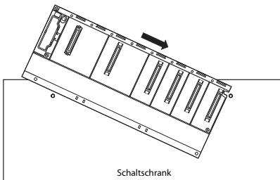
④ Hängen Sie den Baugruppenträger mit der linken oberen Befestigungsoffnung an die andere Schraube.
