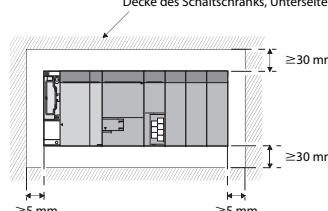
\* Bei einem Kabelkanal, der 50 mm tief ist. In allen anderen Fällen muss der Abstand mindestens 40 mm betragen.
