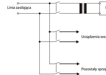
W celu zminimalizowania spadków napięć w linii zasilającej, należy, użyć przewodów o możliwie największej powierzchni przekroju (maks. 2 mm<sup>2</sup>). Celem zabezpieczenia się przed gwałtownymi wahaniem zasilania, należy zainstalować tłumiki przepięć (np. od uderzenie pioruna).
