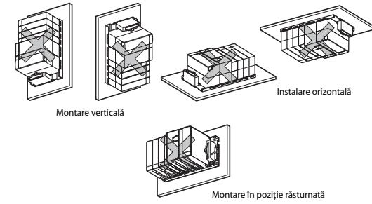
Unitatea de bază trebuie instalată pe o suprafață plană pentru a preveni forțele mecanice.
