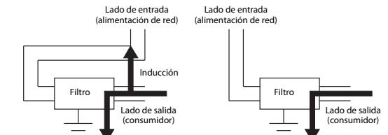
Si se juntan los cables del lado de entrada y de salida, se inducen interferencias al lado de entrada.
