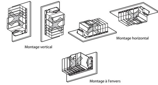
Le châssis de base doit être monté sur une cloison plane pour éviter les contraintes mécaniques.
