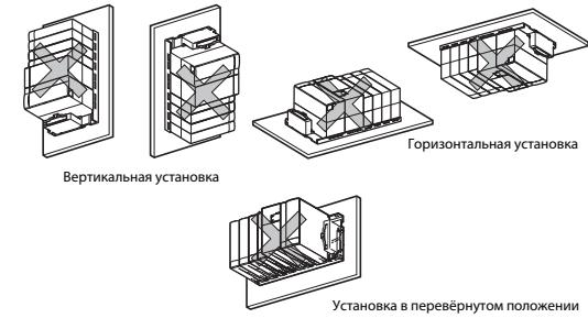
Во избежание механических напряжений базовое шасси необходимо устанавливать на ровной поверхности.
