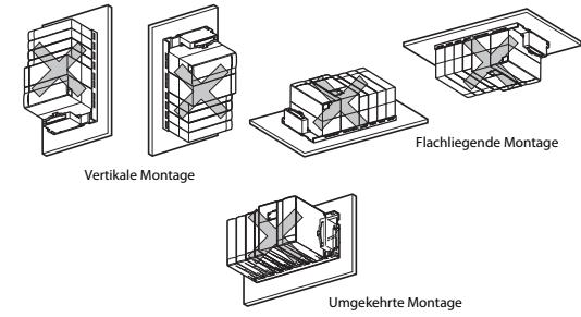
Der Baugruppenträger muss auf einem ebenen Untergrund montiert werden, um ein Verspannen zu vermeiden.
