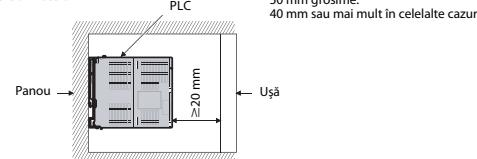
Întrucât PLC-ul generează căldură, acesta trebuie montat într-o locație bine ventilată în orientarea prezentată în partea stângă. PLC-ul nu trebuie instalat în poziție verticală, răsturnat sau în plan orizontal întrucât aceasta nu permite o ventilație suficientă. Nu montați aparatul în niciuna dintre orientările prezentate mai jos.
