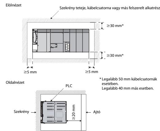
Mivel a PLC üzem közben hő termel, ezért azt egy jó szellőző helyre kell felerősíteni, a bal oldalon látható orientáció szerint. A PLC-t nem szabad merőleges pozícióban, fordítottan vagy egy vízszintes síkon felhasználni mivel az ilyen kialakítások esetében a készülék szellőzése nincs megfelelően biztosítva. A következő ábrán látható felrőrési módok mindenkorrekt helytelen és alkalmazásuk tilos.
