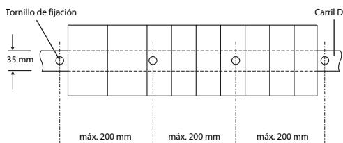
Si el carril DIN se instala en un entorno en el que se producen fuertes vibraciones o choques, hay que colocar los tornillos a una distancia máxima de 200 mm tal como se indica a continuación:
