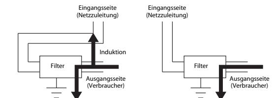
Werden die Leitungen der Ein- und Ausgangsseite gebündelt, werden Störungen in die Eingangsseite induziert.
