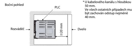
Protože jednotka PLC vydává teplo, musíte ji nainstalovat na dobré odvětrávané místo, tak jak vidíte na obrázku vlevo.
