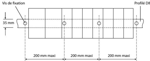
Lors du montage du profilé DIN dans un environnement sujet à des vibrations et/ou des chocs importants, insérez les vis de fixation à des intervalles inférieurs à 200 mm d'après la méthode ci-dessous.
