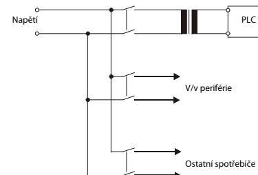
K minimalizaci napěťových úplýtků použijte pro sítové vedení kabel s co největším průřezem (max. 2 mm²).
