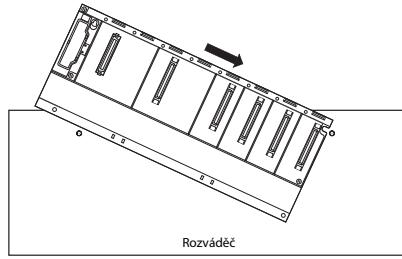
④ Základní sběrnici zavěste nyní pomocí levého horního upevňovacího otvoru na druhý šroub.
