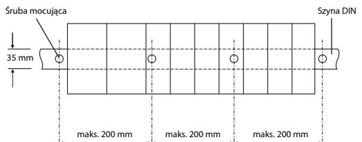
Gdy szyna DIN instalowana jest w środowisku dużych drgań lub podatnym na wstrząsy, należy w odstępach 200 mm, lub mniejszych, wstawić śruby montażowe pokazaną niżej metodą.
