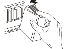
③ Pokud pracujete v prostředí s výskytem vibrací, zajistěte modul dodatečně jedním šroubem M3 x 12 (utahovací moment šroubu: 0,36 až 0,48 Nm). Tento šroub není obsahem dodávky modulu.
