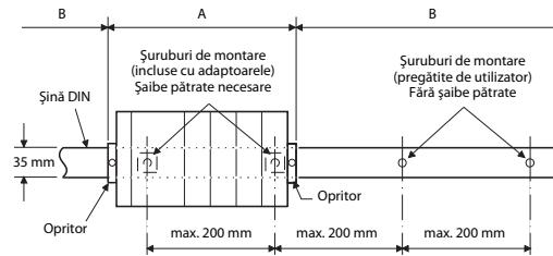
Introduceți șuruburile de montare și șaibele pătrate livrate conform figurii de mai jos.
