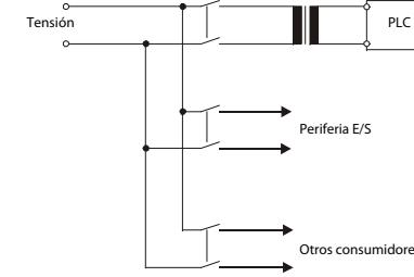
Para la minimización de las pérdidas de tensión, hay que emplear cables con la máxima sección posible (máx. 2 mm<sup>2</sup>). Como protección contra sobretensiones (p.ej. la causada por un rayo) hay que emplear descargadores de sobretensión.
