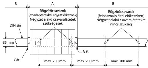
A mellékelt rögzítőcsavarokat és négyzet alakú csavaralátéteket a lenti ábrán látható módon helyezze be.
