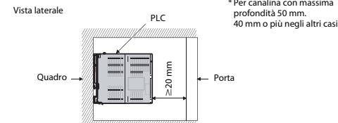
Dato che il PLC genera calore, deve essere montato in una posizione ben ventilata con l'orientamento indicato a sinistra.
