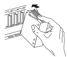
② Seguidamente, empuje el módulo contra la unidad base hasta que el módulo quede perfectamente insertado en la unidad base.
