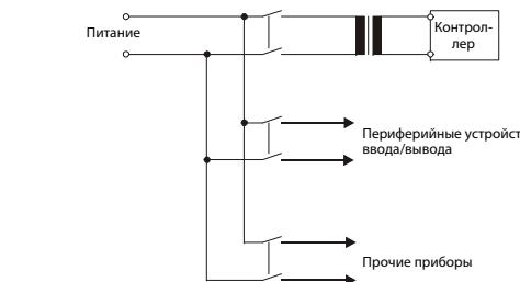
Чтобы свести к минимуму потери напряжения в проводке, для линий питания используйте кабели с максимально возможной площадью поперечного сечения жилы (макс. 2  $\text{mm}^2$ ).
