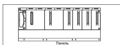
⑤ Вставьте нижние винты и закрепите шасси на стенке, затянув все винты.
