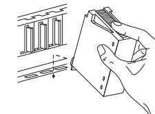
② Appuyez ensuite fermement le module sur le châssis de base et vérifiez qu'il est complètement inséré.
