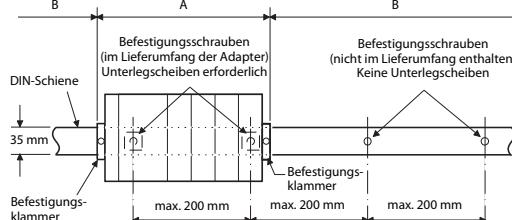
Setzen Sie die mitgelieferten Schrauben und eckigen Unterlegscheiben so ein, wie in der folgenden Abbildung dargestellt.
