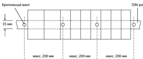
При установке DIN-рейки в условиях сильной вибрации и ударных нагрузок вставьте крепежные винты с интервалом не более 200 мм, как показано на рисунке ниже.
