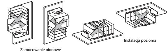
Chcąc nie dopuścić do powstania mechanicznych naprężeń, płytę bazową należy zamontować na ścianie o płaskiej powierzchni.
