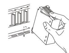
② Następnie zdecydowanie docisnąć moduł do płyty bazowej, uważając, aby został całkowicie wsunięty.
