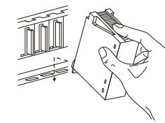
② Drücken Sie das Modul anschließend auf den Baugruppenträger, bis das Modul ganz am Baugruppenträger anliegt.
