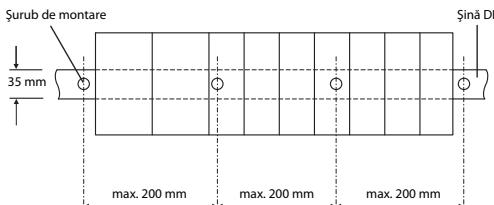
La instalarea șinei DIN într-un mediu expus la vibrații și/sau șocuri puternice, introduceți șuruburile de montare la intervale de 200 mm sau mai mici conform metodei prezentate în continuare.
