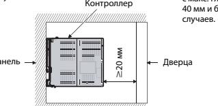
Поскольку контроллер выделяет тепло, его следует устанавливать в месте с достаточной вентиляцией и в положении, показанном слева.
