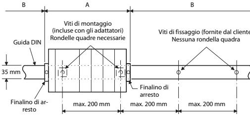
Inserire le viti di fissaggio e le rondelle quadre fornite come mostrato di seguito.
