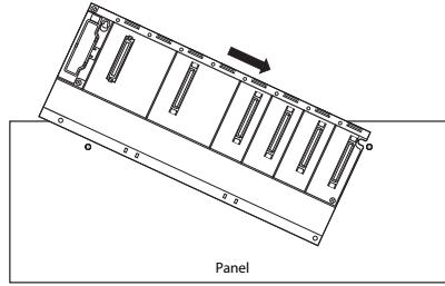
④ Csúsztassa az alapegység bal oldali rögzítőfuratát a másik csavar mellé.
