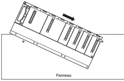
④ Faites glisser le trou de fixation gauche du châssis de base sur l'autre vis.
