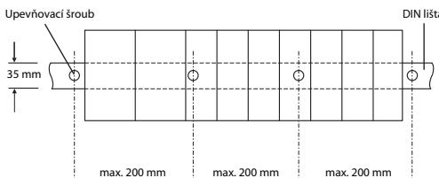
Protože DIN lišta se instaluje v prostředí se silnými vibracemi a/nebo rázy, musí se upevňovací šrouby rozmitit s maximálními rozestupy 200 mm tak, jak je znázorněno dále:
