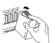
② Затем плотно прижмите модуль к базовому шасси и убедитесь, что он вошел до конца.
