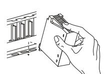
① Po wyłączeniu napięcia zasilania, należy dolny występ modułu wsunąć do prowadzącego otworu, znajdującego się w płytcie bazowej.
