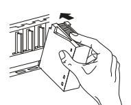
② Appuyez sur le module dans le sens de la flèche pour le placer dans le châssis de base.
