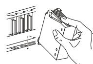
① Après avoir coupé l'alimentation, insérez le verrou de fixation du module dans le trou de fixation du châssis de base.
