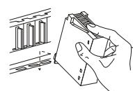
① Una volta disinserita la tensione di rete, introdurre il modulo nella guida del rack con la lingetta inferiore.
