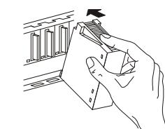
③ W przypadku instalacji modułów w takich miejscach, w których spodziewane są organy, należy moduł zabezpieczyć przy pomocy śruby mocującej (M3 x 12). Śrubę mocującą moduł należy dokręcić momentem od 0,36 do 0,48 Nm. Śruby te nie są dołączane wraz z modułami.
