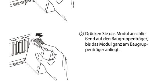
③ Sichern Sie das Modul zusätzlich mit einer Schraube (M3 x 12), wenn Vibrationen zu erwarten sind (Anzugsmoment der Schraube: 0,36 bis 0,48 Nm). Diese Schraube gehört nicht zum Lieferumfang der Module.
