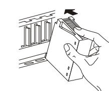
Diagramă care ilustrează pasul 3: Fixați modulul cu un șurub de fixare (M3 x 12) în locațiile de instalare unde pot apărea vibrații. Strângeți șurubul de fixare a modulului cu un cuplu de 0,36 – 0,48 Nm. Aceste șuruburi nu sunt incluse cu modulele.
