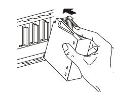
③ Fixez le module avec une vis M3 x 12 aux emplacements où des vibrations sont probables. Serrez la vis de fixation du module à un couple compris entre 0,36 et 0,48 N.m. Ces vis ne sont pas fournies avec les modules.
