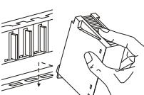
① A tápellátás kikapcsolását követően, helyezze be a modul alsó körmét az alapegyeségen lévő bevezető lyukba.
