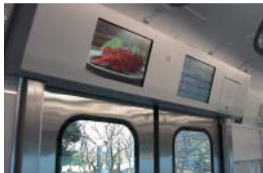
Fig. 4 VIS Media Display Unit
