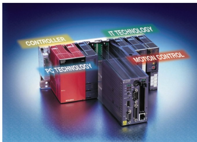
1. ábra Az egy platformba ültetett akár négy processzor osztozik a vezérlés, adatfeldolgozás, mozgásvezérlés és kommunikáció feladatain
