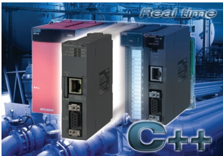
2. ábra A C-vezérlő lehetővé teszi a PC-alapú, valós idejű, operációs rendszerű ipari vezérlések programozását magas szintű nyelveken
