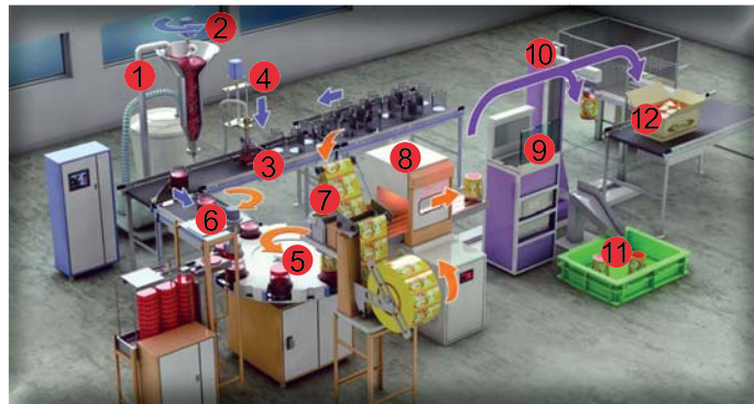
1. ábra Több FX-rendszer összekapcsolása komplett csomagolósor vezérléséhez: 1. Szelepvezérlés 2. Csiga 3. Tégelymegállító kapcsoló 4. Töltőmechanizmus 5. Büttyös asztal 6. Fedélfelhelyező nyomaték-szabályozással 7. Csomagolásfelhelyező manuális impulzusgenerátorral 8. Hőkezelő alagút zsugorfóliázáshoz 9. Tesztkamera 10. Átrakó 11. Selejtes láda 12. Végtermék elhelyezése
